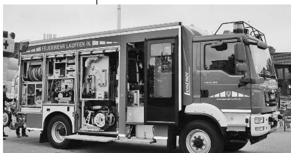
HLF 20 mit Gerät zur Technischen Hilfeleistung und Schnellangriffseinrichtung zur Brandbekämpfung.
