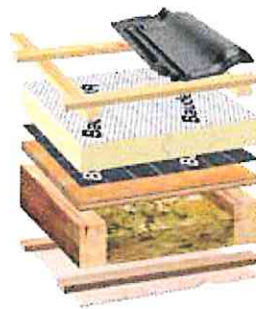
Luftdichte Schicht auf vorhandener Holzschalung unter neuer Aufsparrendämmung
