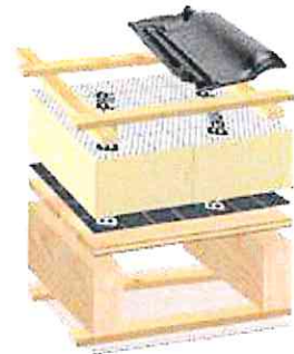
Luftdichte Schicht auf neuer Holzschalung unter neuer Aufsparrendämmung
