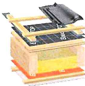
Naht- und perforationsgesicherte Unterdeckung auf Holzschalung (mit Bauder Nageldichtstreifen)
