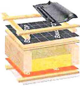
Verklebte Unterdeckung auf Holzschalung
