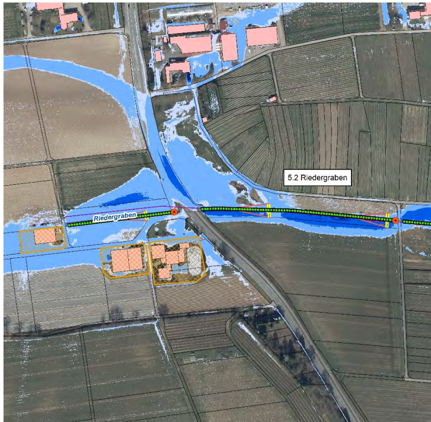
Abbildung 34: Mögliche Maßnahmen im Bereich Riedergraben West
