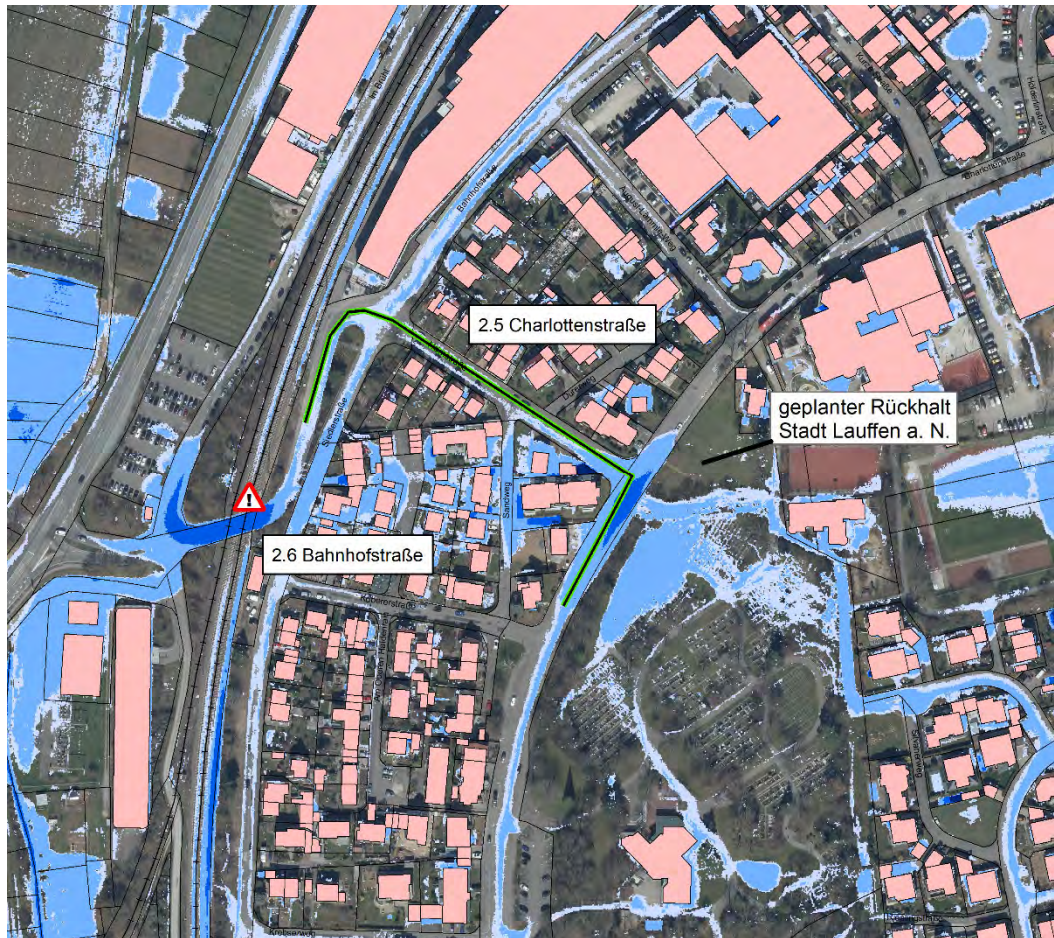
Abbildung 27: Mögliche Maßnahmen im Bereich Charlottenstraße
