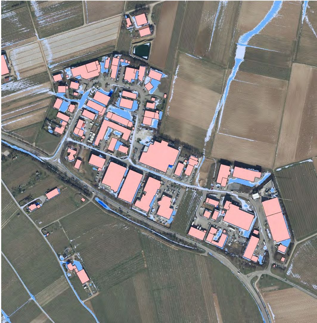
Abbildung 13: Übersicht der Überflutungstiefen in dem Bereich Burgfeld bei einem außergewöhnlichen Ereignis
