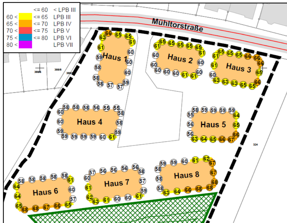
Abb. Maßgebliche Außenlärmpegel in dB(A) und Lärmpegelbereiche (LPB), Ausschnitt aus Plan Nr. 6587-230-10 der schalltechnischen Untersuchung vom 14.11.2023
