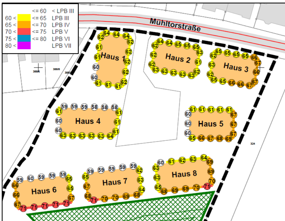
Abb. Maßgebliche Außenlärmpegel in dB(A) und Lärmpegelbereiche (LPB), Ausschnitt aus Plan Nr. 6587-230-12 der schalltechnischen Untersuchung vom 14.11.2023
